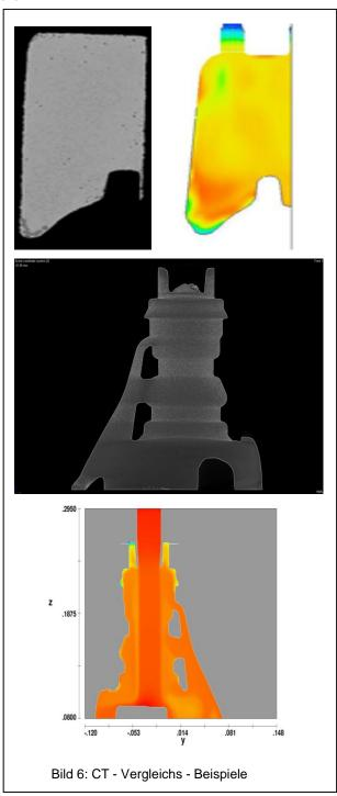
Hier wird mit Hilfe des CT – Scan – Verfahrens versucht die Simulationsergebnisse der Verteilung der Packungsdichte des Kerns zu verifizieren. Dies ist auf Grund der Einflussfaktoren der Graustufendarstellung der CT-Auswertung nicht einfach.
