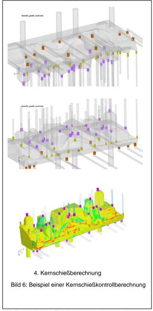
Auf Basis dieses Ergebnisses wurde der Kernkasten ausgelegt und kam im Jahr 2007 auch so zum Einsatz. Die Kerne aus der ersten Fertigung waren direkt für die Produktion geeignet und im Zuge mehrerer Produktionstage wurden nur 2 Düsen ergänzt.
